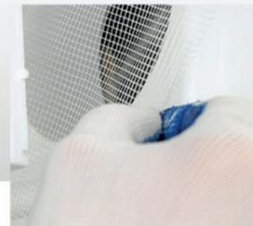
**4** Filterfließ absaugen oder auswaschen, anschließend trocknen lassen und wieder einsetzen
