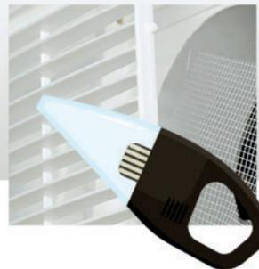
**3** Bei größeren Verschmutzungen den Staubsauger benutzen
