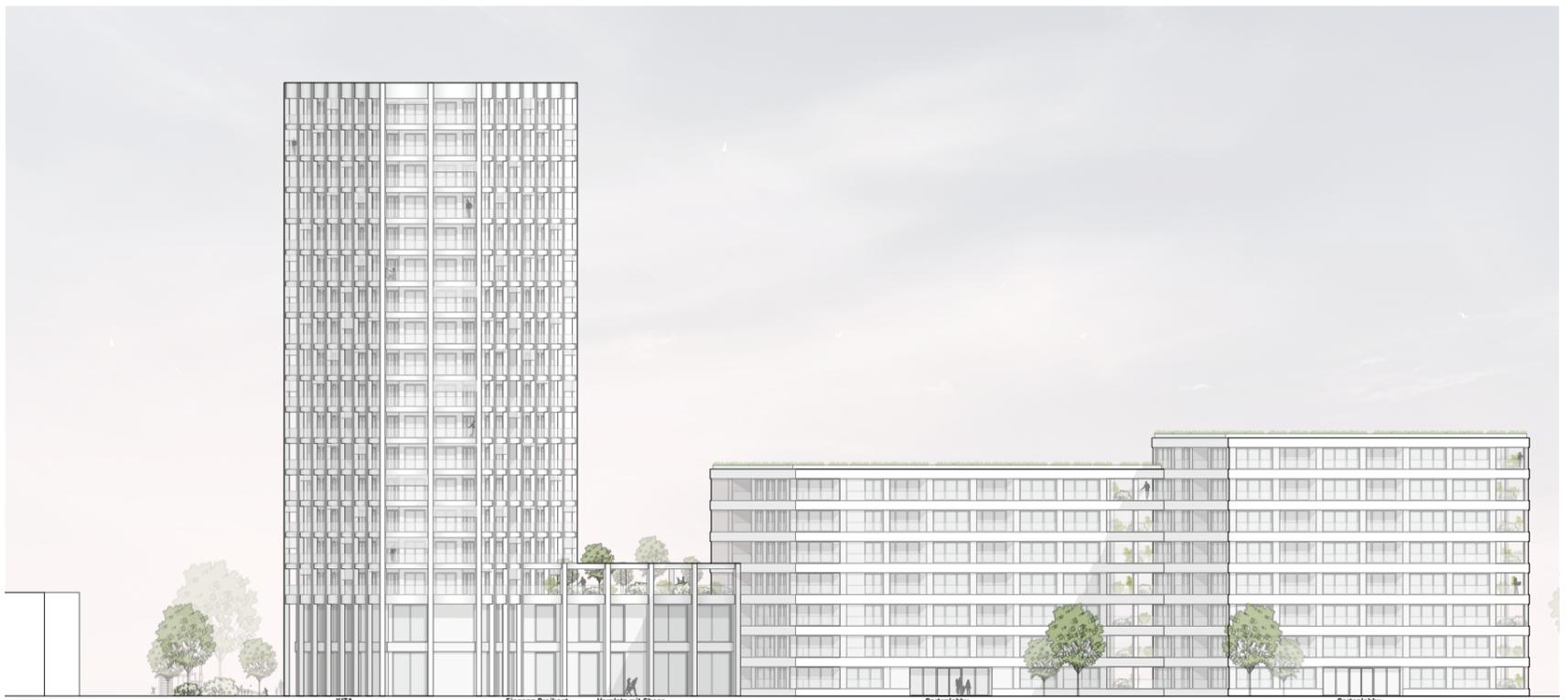
Die Belange des Schallschutzes werden in dem Entwurf in der städtebaulichen Konfiguration und der Grundrissgestaltung gelöst. Gleichzeitig soll man den Gebäuden ihre schallbelastete Exposition nicht ansehen. Schützenwerte Räume sind alle schallabgewandt orientiert. Wohnzimmer erhalten in Eckausrichtung sowohl die sonnenbeschienene Südfassade und die ruhige Nordost- bzw. Nordwestfassade. So lassen sich bauliche Schallschutzmaßnahmen auf ein Minimum reduzieren.
